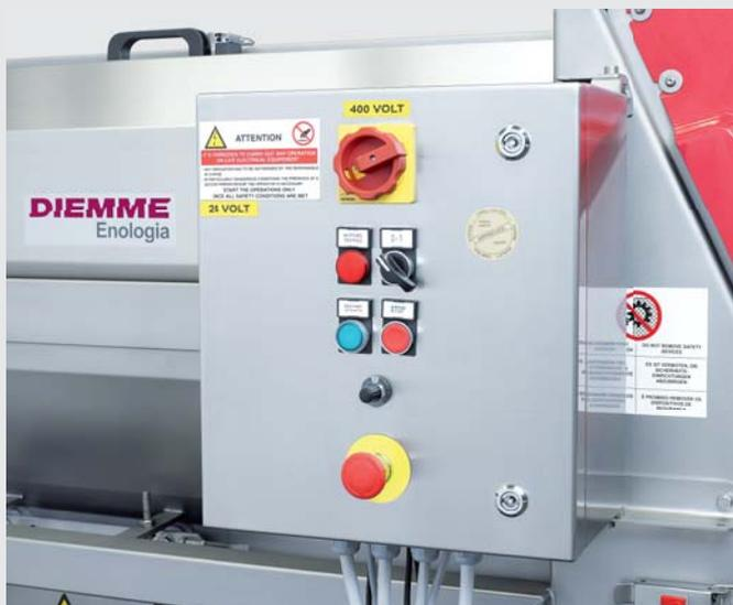
**IT** Controllo della macchina tramite quadro remoto con regolazione della velocità di rotazione tramite Inverter.
