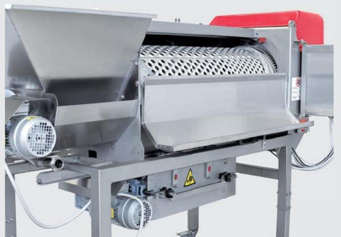
**IT** Gruppo pigiante a rulli in gomma alimentare monoblocco regolabile nell'azione pigiante. \*Sicurezza contro l'intrusione di corpi estranei nel gruppo pigiante [A].
